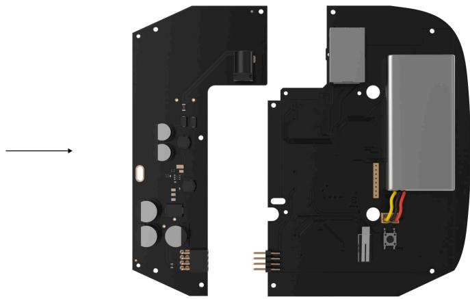
**9.** Setzen Sie die Platinen in das Gerätegehäuse und ziehen Sie die Schrauben an.
