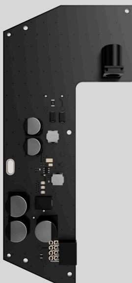
Das **12V PSU for Hub/Hub Plus/ReX** ermöglicht den Betrieb der Alarmzentralen Hub und Hub Plus sowie des Funk-Repeaters ReX an 12-V-Gleichspannungsquellen. Dabei handelt es sich um eine elektronische Platine, die die standardmäßige 110/230-V-Netzteilplatine im Gehäuse des Geräts ersetzt.
