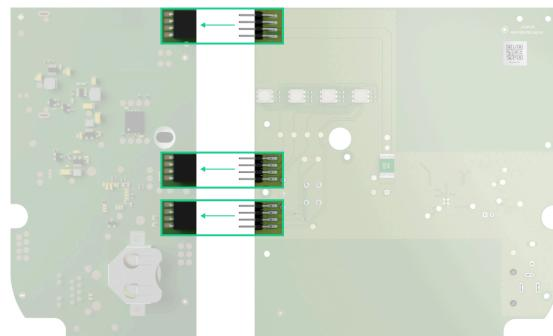
Achten Sie bitte darauf, dass die Platinenkontakte in die untere Reihe des Steckverbinder (der Platine am nächsten) gesteckt werden. Bei korrektem Anschluss befinden sich die Platinen in einer Ebene.
