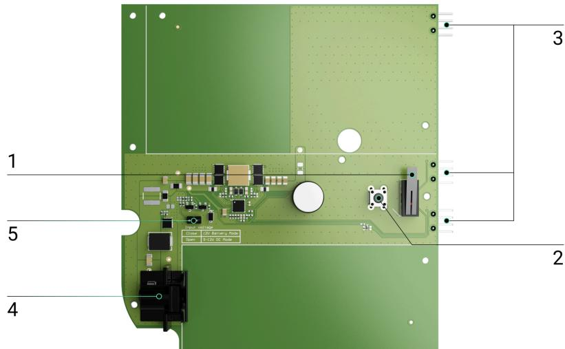
1. Sabotagekontakt. Dieser wird ausgelöst, wenn der Gehäusedeckel des NVR entfernt wird.
