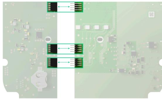
**9. Installieren oder entfernen Sie den Jumper, je nach Betriebsmodus.**
