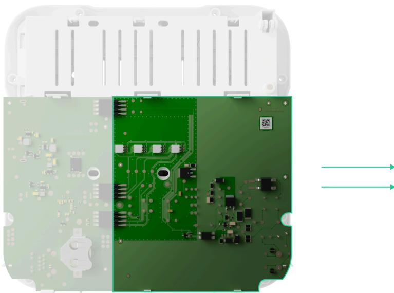
**8. Ziehen Sie die Stromversorgungsplatine (die größere Platine) von der Hauptplatine ab.**
