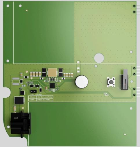
**12V PSU for NVR** ist eine alternative Stromversorgungsplatine, die verwendet wird, um einen [Ajax NVR](#) Netzwerkvideorekorder an eine 8–16 V– Stromversorgung anzuschließen. 12V PSU for NVR ist eine elektronische Platine, die in das Gehäuse des Netzwerkvideorekorders eingebaut wird und die standardmäßige 110/230 V~ Stromversorgungsplatine ersetzt.
