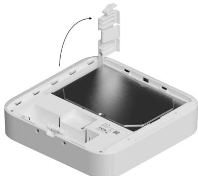
**5. Entfernen Sie die Festplatte aus dem NVR-Gehäuse.**
