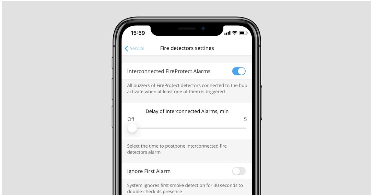
5. Aktivieren Sie ggf. die Option **Rauchalarm Doppelprüfung**. Diese Funktion wird empfohlen, falls sich am Objekt potenzielle Quellen für Falschalarme befinden. Diese können beispielsweise solche mit hoher Dampf- oder Staubentwicklung sein.
