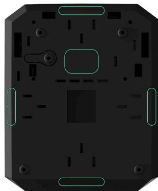
**4.** Befestigen Sie das Gehäuse mit den mitgelieferten Schrauben an einer senkrechten Fläche am gewählten Montageort. Verwenden Sie alle Befestigungspunkte des Gehäuses. Einer davon, im perforierten Teil der Halterung über dem Manipulationsschalter, wird benötigt, um den Manipulationsschalter auf der Rückseite der Platine auszulösen, falls versucht wird, das Gehäuse von der Oberfläche abzureißen.
