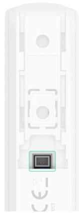
Wir empfehlen, den kabelgebundenen Melder in einem Abstand von nicht mehr als 1 Meter zu GlassProtect zu installieren. Längere Drahtlängen erhöhen das Risiko seiner Beschädigung und verringern die Qualität der Kommunikation zwischen den Melder.
