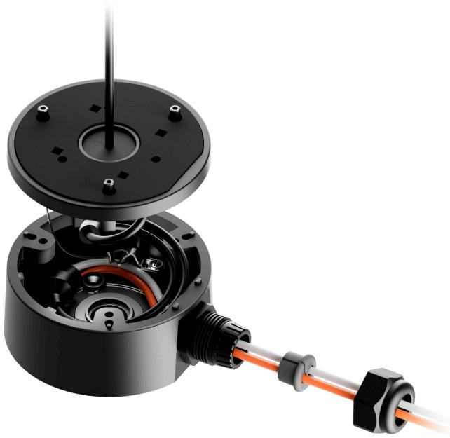
JunctionBox ist mit einem Sicherungsdraht ausgestattet, um den Deckel während der Installation zu fixieren. Dieser verhindert, dass der Deckel von der Anschlussdose abfällt, bis er mit Schrauben befestigt wird. Der Sicherungsdraht wird an die Erdungsklemme angeschlossen.
