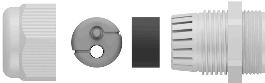
2. Den **grauen** Gummidichtungsring entlang der Schnittlinien entsprechend der Anzahl der Kabel schneiden. Der **schwarze** Gummiring muss unversehrt bleiben.
