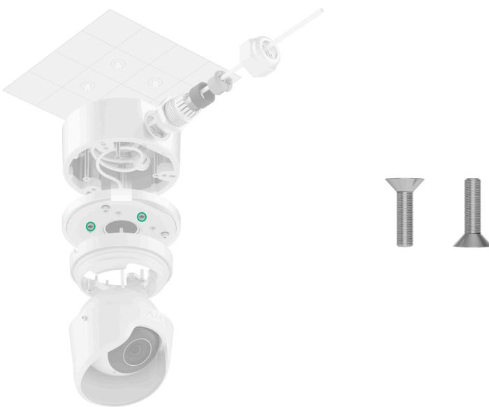
3. Das Kameragehäuse an den Halter anbringen. Dabei sicherstellen, dass das Kameraobjektiv auf den geschützten Bereich ausgerichtet ist. Das Kameragehäuse sichern, indem der beiden Schrauben im Halter mit dem mitgelieferten Sechskantschlüssel ( $\varnothing$  2 mm) festgezogen werden.
