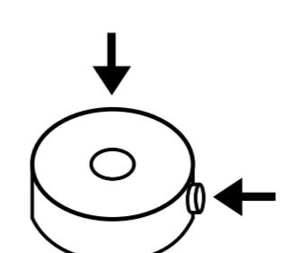
Zwei Montagemöglichkeiten der Kabelverschraubung: oben oder seitlich
