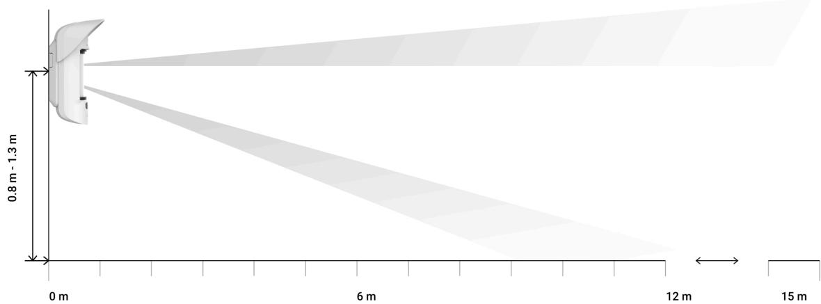
Der Erfassungsbereich wird mit dem Schieberegler **Erfassungsreichweite** auf der Rückseite des Melders eingestellt. Berücksichtigen Sie bei der Wahl des Montageortes den maximalen Erfassungsbereich des Melders. Er ist abhängig von der Empfindlichkeit, der Stellung des Schiebereglers "Erfassungsreichweite", der Art und Geschwindigkeit der Bewegung der Person (Laufen, Gehen) und der Umgebungstemperatur.
