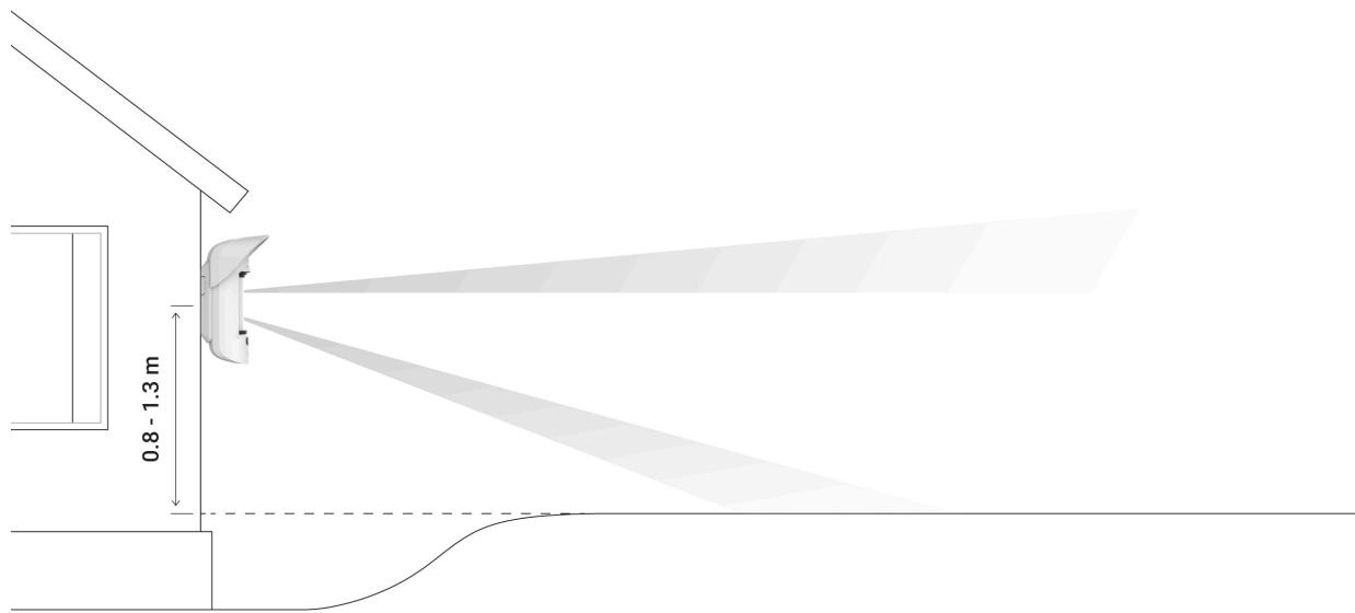
Der Melder sollte auf einer ebenen, stabilen Fläche montiert werden, z.B. an einer Hauswand oder an einem Zaun. Wenn der Melder auf einer wackeligen (instabilen) Oberfläche installiert wird, kommt es zu Falschalarmen.
