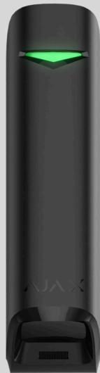
**MotionProtect Curtain** ist ein kabelloser Vorhang-Bewegungsmelder. Der für den Innenbereich ausgelegte Melder mit einem engen horizontalen Erfassungswinkel soll Fenster, Türen und andere Ein- und Ausgänge in der geschützten Einrichtung überwachen. MotionProtect Curtain erkennt Bewegungen in einer Entfernung von bis zu 15 Metern.
