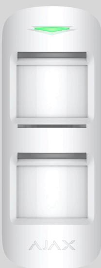
**MotionProtect Outdoor Jeweller** ist ein kabelloser Bewegungsmelder für den Außenbereich. Die Reichweite der Bewegungserfassung ist einstellbar und kann bis zu 15 Meter erreichen. Der Melder verfügt über ein Anti-Masking-System, das Versuche erkennt, die Sicht des Geräts zu behindern. Bei richtiger Montage und Einstellung reagiert der Melder nicht auf Tiere bis zu einer Größe von 80 cm.
