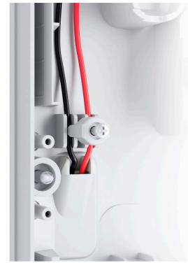
7. Bereiten Sie die Drähte für den Anschluss vor. Die Enden der Drähte, die in die Klemmen gesteckt werden, sollten verzinnt oder mit speziellen Spitzen gecrimpt werden. Dadurch wird eine zuverlässige Verbindung gewährleistet.
