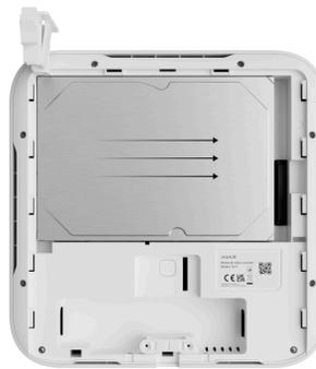
5. Schließen Sie die Festplattenverriegelung.
