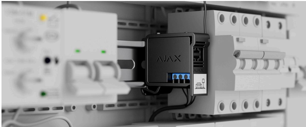
Das 39 × 33 × 18 mm große Gerät wird in die Schaltlücke eingebaut. Die Maße des Relay Jeweller ermöglichen den Einbau des Geräts in eine tiefe Abzweigdose, in den Schaltschrank eines Elektrogeräts oder in einen Verteilerkasten. Die flexible externe Antenne sorgt für eine stabile Kommunikation. Für die Installation des Relay Jeweller auf einer DIN-Schiene empfehlen wir die Verwendung einer DIN Holder.
