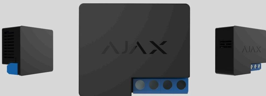
**Das Relay Jeweller** ist ein Relais mit potenzialfreien Kontakten zur Fernsteuerung eines Stromkreises. Die potentialfreien Kontakte des Relais sind vom Stromversorgungskreis des Geräts elektrisch vollständig getrennt. Der Relay Jeweller kann sowohl in Schwachstrom- als auch in Haushaltsstromnetzen eingesetzt werden. Das Gerät verfügt über zwei Schutzarten: Spannungs- und Temperaturschutz.
