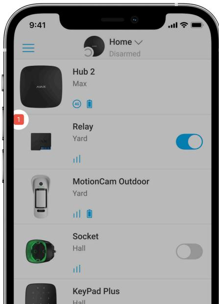
Im Falle einer Störung des Relays (z.B. kein Jeweller-Signal zwischen der Hub-Zentrale und dem Relay), zeigt die Ajax-App einen Störungszähler in der oberen linken Ecke des Gerätesymbols an.
