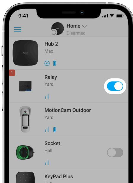
Mit den Ajax-Apps können Sie elektrische Geräte ein- und ausschalten, die an einen von einem Relay Jeweller gesteuerten Stromkreis angeschlossen sind.
