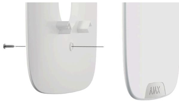
11. Bringen Sie die Kunststoffschutzplatte (das Ajax Logo auf der Anschlussseite des LED-Streifens an die Platine) mit wenig Kraft an. Die korrekt montierte Kunststoffplatte ragt nicht mehr als 1,0 bis 1,5 mm über den LED-Rahmen hinaus.
