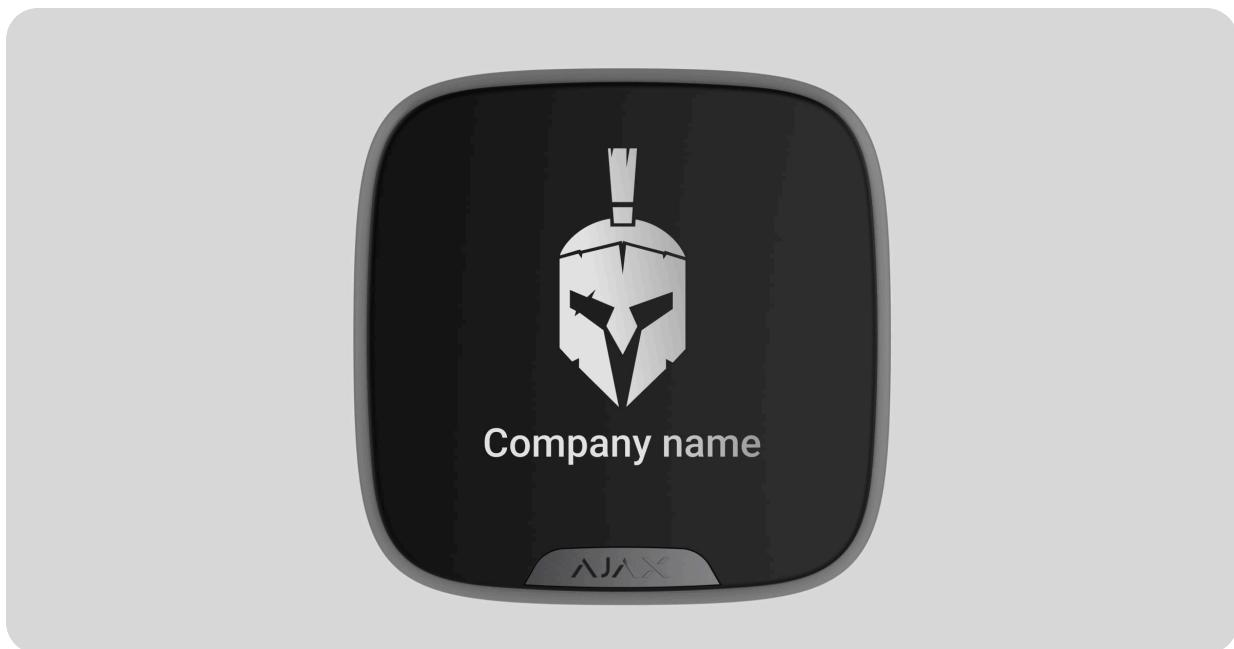
**StreetSiren DoubleDeck** ist eine kabellose Sirene für den Außenbereich mit einer Halterung für die Marken/Logo-Blende. Die mit einem LED-Rahmen und einem Piezo-Summer mit bis zu 113 dB Schalldruck ausgestattete StreetSiren kann mit den vorinstallierten Batterien bis zu 5 Jahre betrieben werden. Sie kann auch von einer externen 12-V-Stromversorgung gespeist werden.
