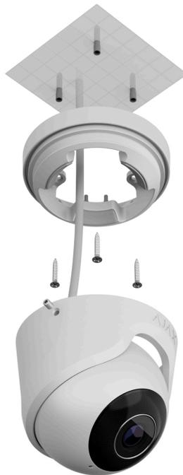
8. Das Kameragehäuse in den Halter einsetzen. Dabei sicherstellen, dass das Kameraobjektiv gegenüber dem geschützten Bereich liegt. Das Kameragehäuse sichern, indem der beiden Schrauben im Halter mithilfe des Bündel-Sechskantschlüssels ( $\varnothing$  2 mm) festgezogen werden.
