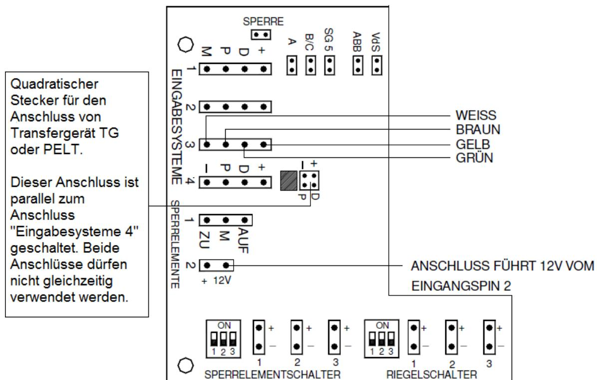
Anschaltung Funk-Empfänger-Einheit an Eingabesysteme-Eingang (1 – 4) der AE255F
