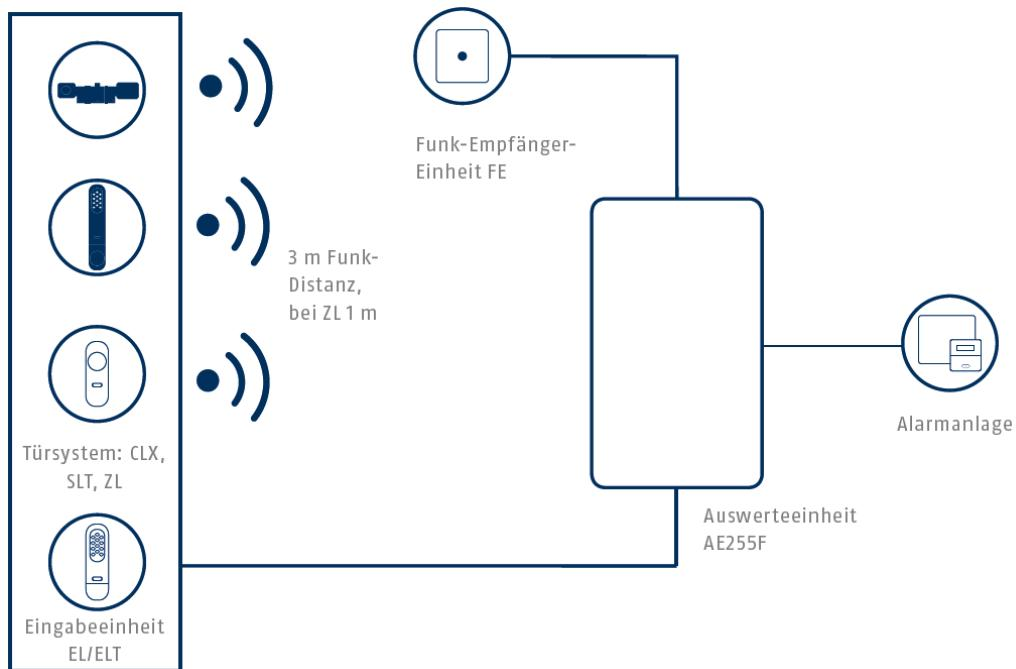
Mit der Auswerteeinheit AE255F können bis zu vier kabelgebundene Türsysteme zur SCHARF- und UNSCHARF-Schaltung eingesetzt werden. Bei Verwendung der Funk-Empfänger-Einheit können bis zu vier Funk-Empfänger-Einheiten angeschlossen werden, die jeweils bis zu 10 funkgebundene Türsysteme erfassen können.
