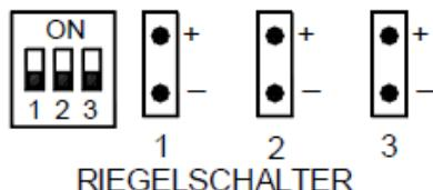
Die geschlossenen Riegelschalter sind eine Scharfschaltbedingung.
