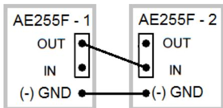
Anschluss OUT von AE255F – 1 an Anschluss IN von AE255F – 2 anschließen.
