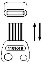
Zur Bedienung mit dem ABUS Seccor Chip-Schlüssel wird der Schlüssel in das Lesemodul (Leseschlitz) eingeschoben und wieder herausgezogen. Der ABUS Seccor Chip-Schlüssel ist ein Wendeschlüssel, die Steckrichtung ist variabel.
