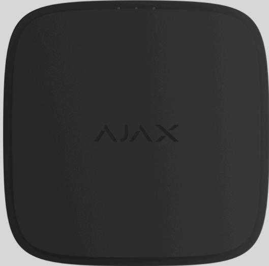
**EN54 FireProtect (Heat/Sounder) Jeweller** ist ein Funk-Wärmemelder mit Sirene. Er erfüllt die Anforderungen der EN 54-5 für Wärmemelder der Klassen A1, B und C mit Reaktionstypen Temperaturanstieg (R) und statisch (S). Das Gerät erkennt gefährliche Temperaturen und sorgt für einen akustischen Alarm, wenn der Feueralarm in der Einrichtung aktiviert wird.
