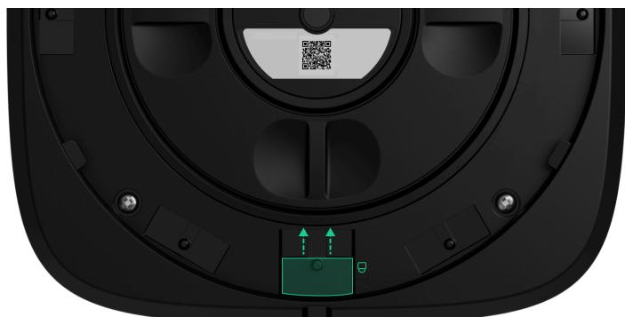
9. Installieren Sie das Getät an der SmartBracket-Montageplatte.
