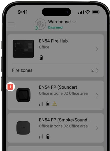
Wenn ein Fehler des EN54 FireProtect (Sounder) Jeweller erkannt wird, zeigt eine Ajax App einen Fehlerzähler auf dem Gerätesymbol an. Alle Fehler werden in den Gerätezuständen angezeigt. Die Felder mit Fehlern sind gelb markiert. Außerdem werden die Fehler auf der Registerkarte **Kontrolle** des CIE-Bildschirms angezeigt. Weitere Einzelheiten zu dem Fehler finden Sie auf den Registerkarten **Ereignisübersicht** oder **Brandzonen** der CIE.
