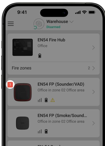
Wenn ein Fehler des EN54 FireProtect (Sounder/VAD) Jeweller erkannt wird, zeigt eine Ajax App einen Fehlerzähler auf dem Gerätesymbol an. Alle Fehler werden in den Gerätezuständen angezeigt. Die Felder mit Fehlern sind gelb markiert. Außerdem werden die Fehler auf der Registerkarte **Kontrolle** des CIE-Bildschirms angezeigt. Weitere Einzelheiten zu dem Fehler finden Sie auf den Registerkarten **Ereignisübersicht** oder **Brandzonen** der CIE.
