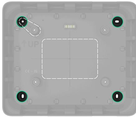
5. Demontieren Sie die erforderlichen Kabelverschraubungen. Führen Sie die vorbereiteten Kabel durch sie hindurch.
