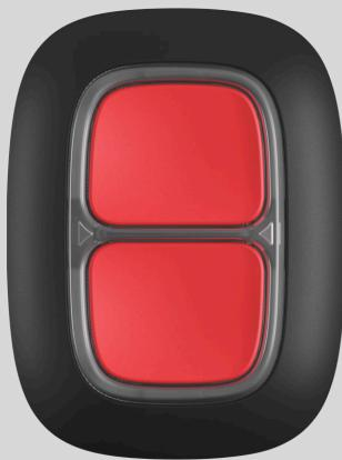
**DoubleButton** ist ein kabelloser Notfallknopf mit erweitertem Schutz gegen versehentliches Drücken. Er arbeitet als Teil das Ajax-System und kommuniziert mit der Hub-Zentrale über das gesicherte Funkprotokoll Jeweller. Die Kommunikationsreichweite zur Hub-Zentrale beträgt ohne Hindernisse bis zu 1300 Meter. Die mitgelieferte Batterie kann das Gerät bis zu 5 Jahre lang am Laufen halten.
