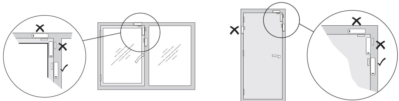
Der Sensor und der Magnet können gegenüber positioniert werden, solange:
